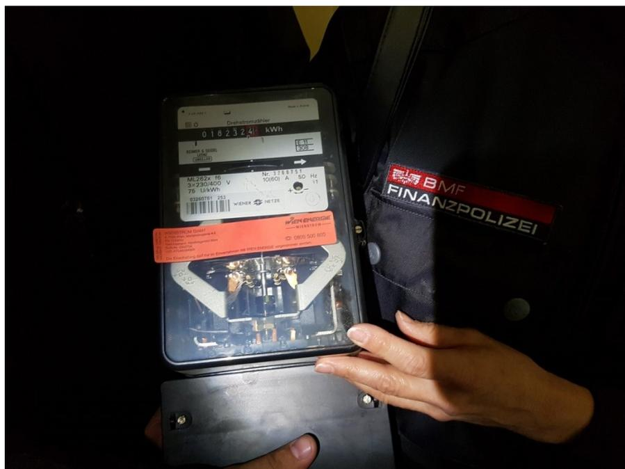
(Abb. 12: Demontierter Stromzähler nach entdecktem Stromdiebstahl)
